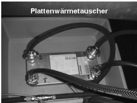
Abb.5. Plattenwärmetauscher des Kraftstoffkühlers
