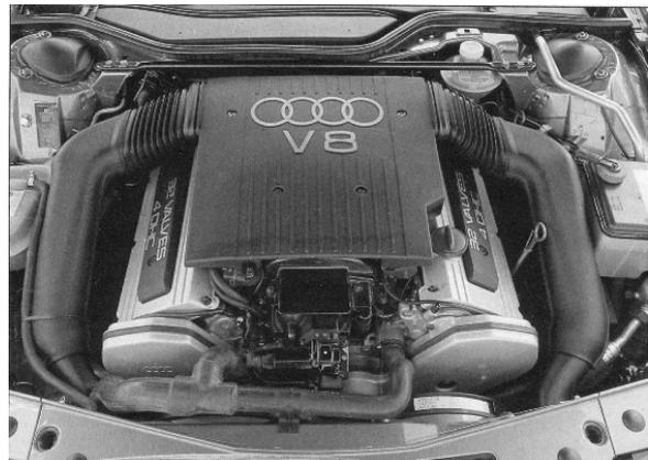
Abb.3. V8-4.2 Liter Benzinmotor des Testfahrzeugs (Audi S4)
