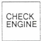
**Schadstoff-Check-Diagnose-Warnleuchte - rot** GD85A-Ba
